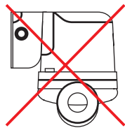
Варианты установки циркуляционных электронасосов с «мокрым» ротором
